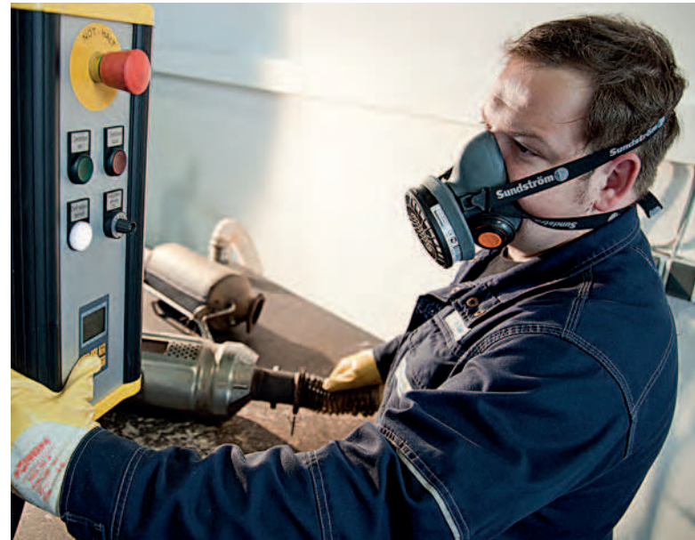
Druckprüfung bei der Rußpartikelfilterreinigung.
